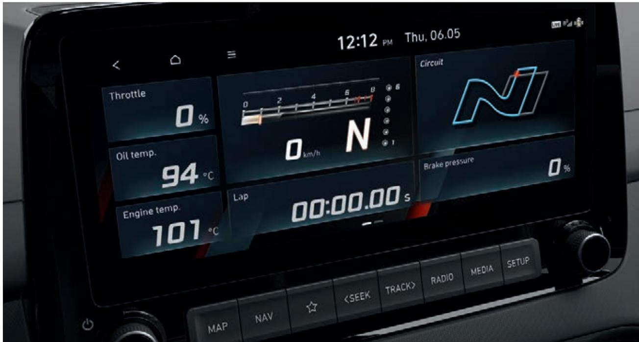
Und damit Sie Ihre Fahrleistung immer im Blick haben und noch weiter verbessern können, ermöglicht das Performance Driving Data System die Anzeige von Fahrdaten auf dem optimal platzierten 10.25"-Touchscreen. Zu den verfügbaren Fahrdaten zählen: PS, Drehmoment, Ladedruck und G-Kraft sowie ein Laptimer und Beschleunigungsmesser.
